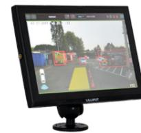
Un écran tactile qui permet de déterminer la zone à sécuriser en suivant la trajectoire des cônes de signalisation positionnés au préalable.
